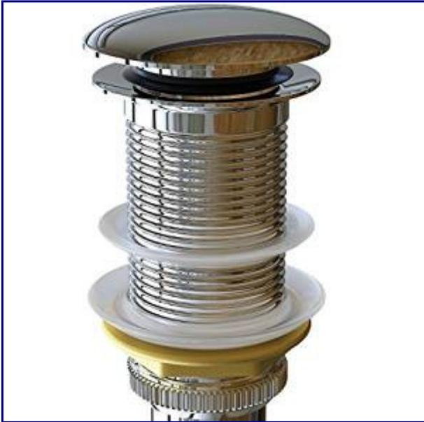
Achten Sie bei der [Ablaufgarnitur](#) darauf, daß diese **keinen Überlauf** hat! Da die Steinwaschbecken nicht doppelwandig wie normale Keramikwaschbecken hergestellt werden können, muß die Ablaufgarnitur rundherum (Gewindestutzen) geschlossen sein, da sonst das Wasser an der Seite austritt. Der hier abgebildete [Ablauf](#) ist z.B. geeignet für Aufsatzwaschbecken aus Naturstein.
